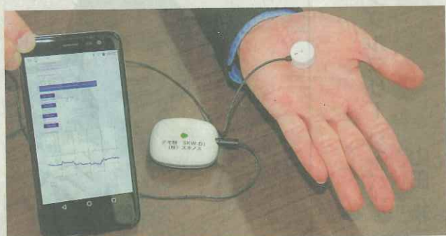
計測器(手のひらの上)で汗のかき方の変化を捉え、スマホに表示するシステム。スキノスなどがウェアラブル機器として商品化する
